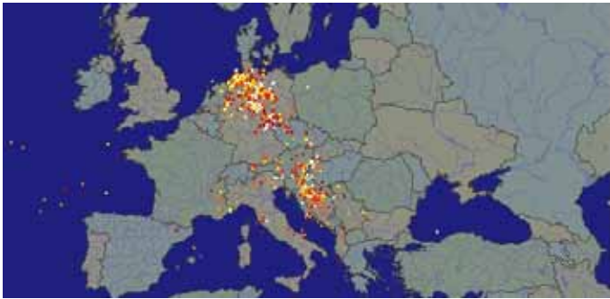
Warner im Internet: Bildschirm von Blitzortung.org – die farbigen Punkte markieren die georteten Sferics.
